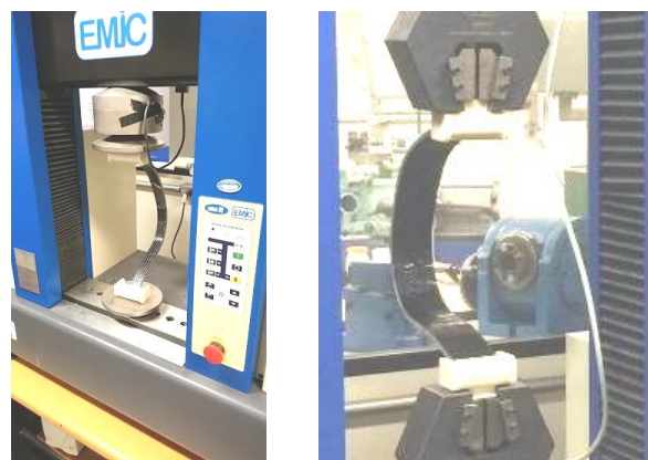
Figura 09 – Testes de compressão das peças
