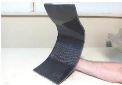
Figura 06 – Prótese “J” – composição de fibra de vidro e carbono
