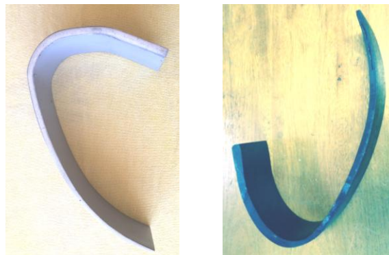
Figura 08 – Formato “C” em fibra de carbono
